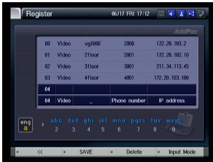
Рисунок 3-38 Удерживайте клавишу указанную на рисунке в течении 3 секунд для перемещения к следующему пункту записи
