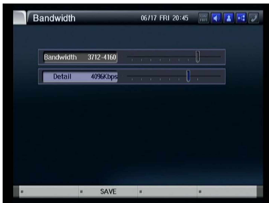
Рисунок 3-111 В пункте "Detail" – точная настройка полосы пропускания. Сохранение изменений – клавиша F2.
