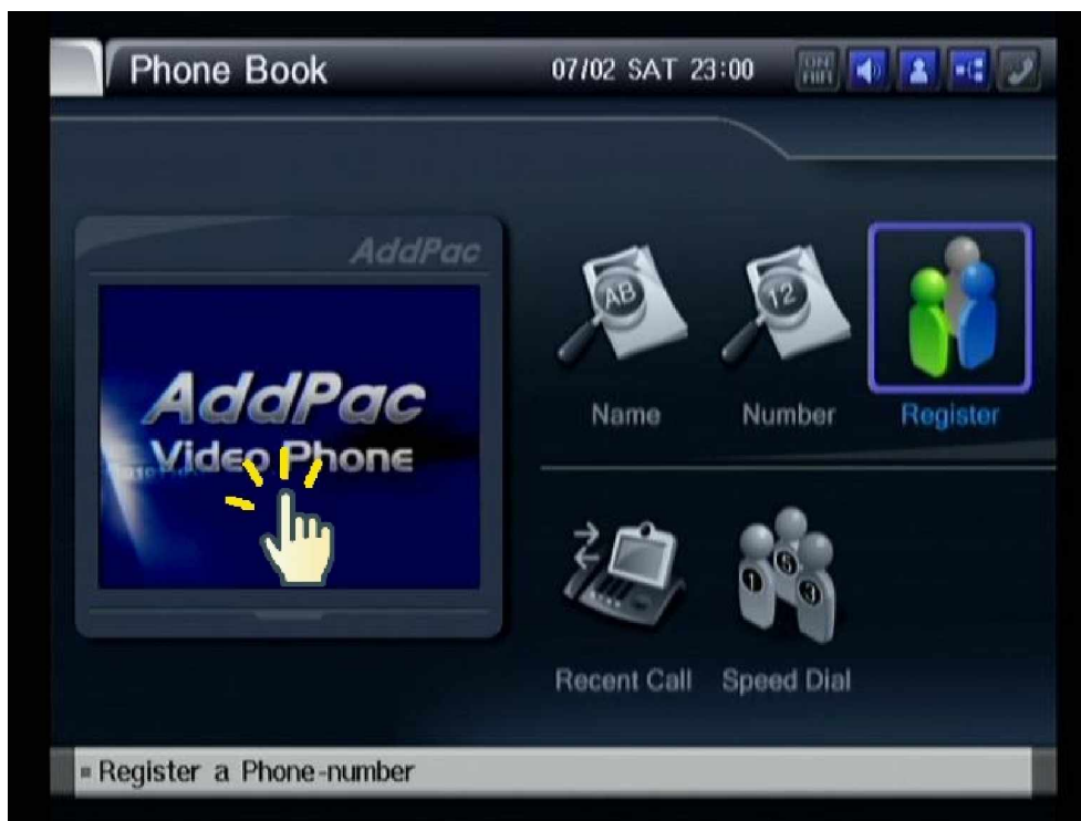
Рисунок 5-11 При нажатии на указанную область AP-VP300 переключится к виду "Local View" и развернет область воспроизведения видеоинформации на весь экран
