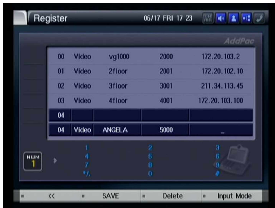
Рисунок 3-43 Удерживайте клавишу указанную на рисунке в течении 3 секунда для перемещения в секцию "IP address"
