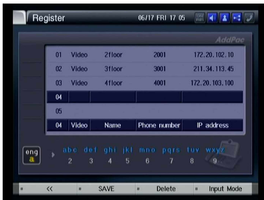
Рисунок 3-37 Выберите тип звонка аудио/видео с помощью наборного поля
