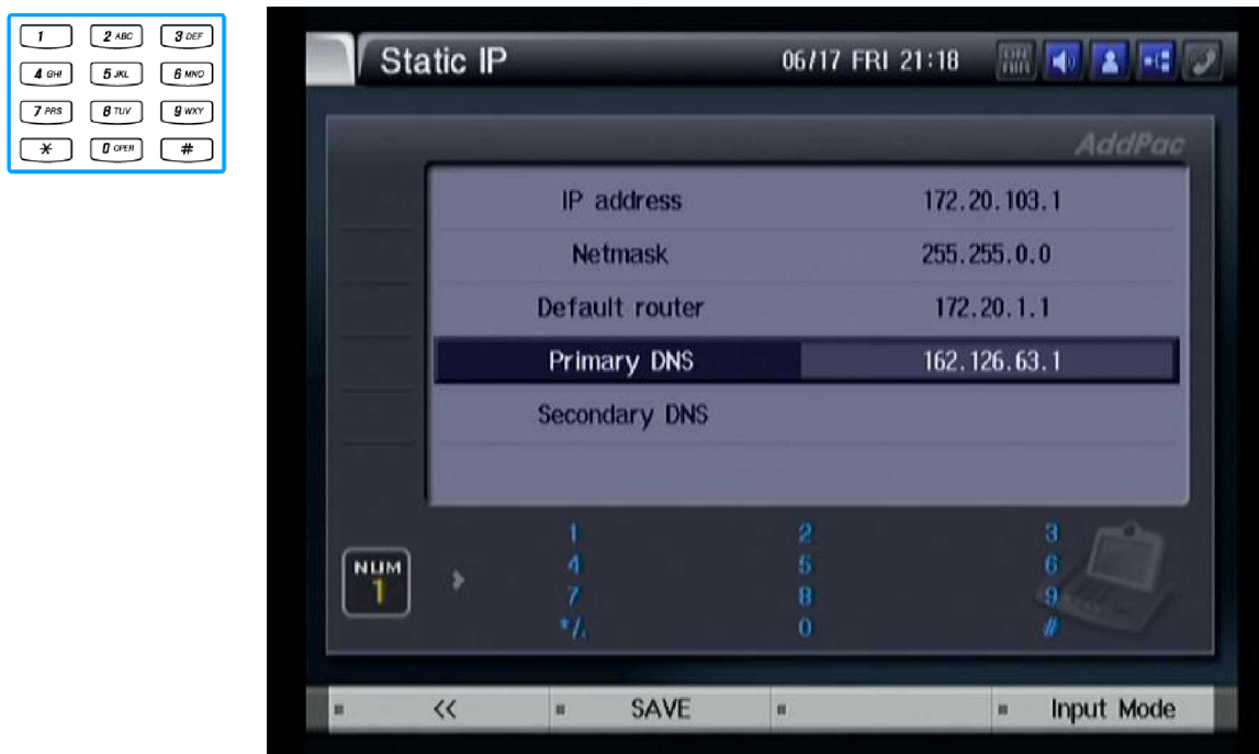
Рисунок 3-130 В меню "Static IP" в поле "Primary DNS" введите IP адрес предпочитаемого DNS сервера (для примера: '168.126.63.1')
