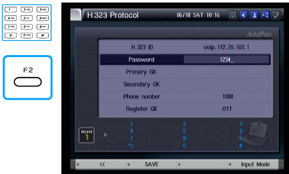
Рисунок 3-150 В поле "Password" укажите пароль для регистрации на Gatekeeper
