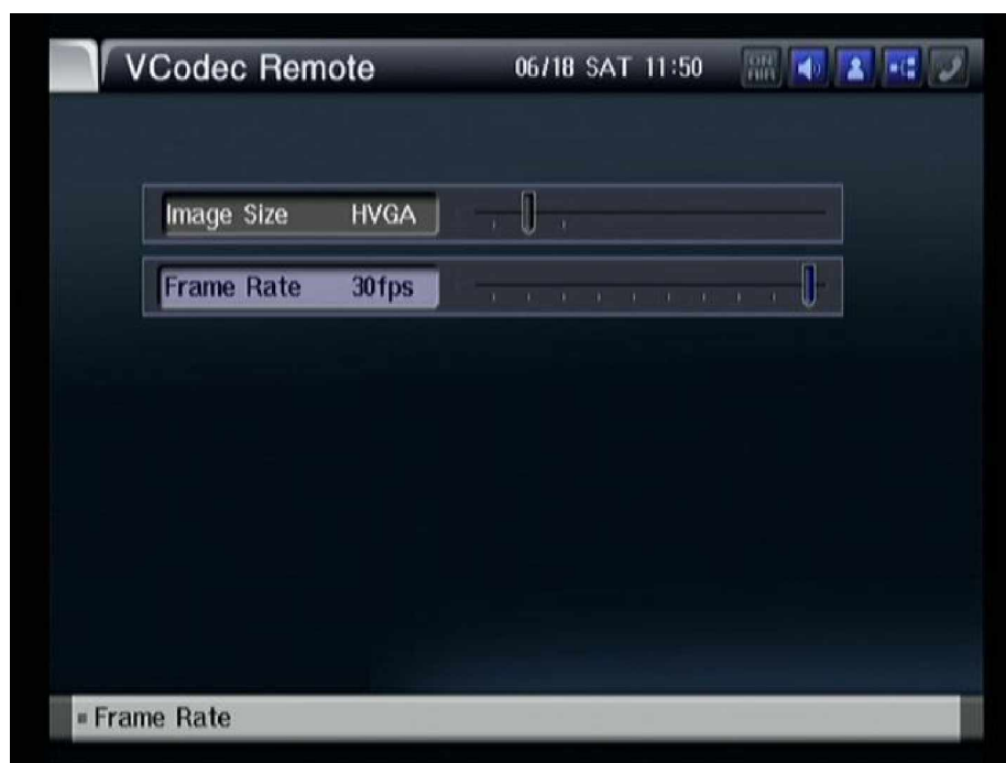
Рисунок 3-171 В поле "Frame Rate" установите требуемую частоту передачи кадров
