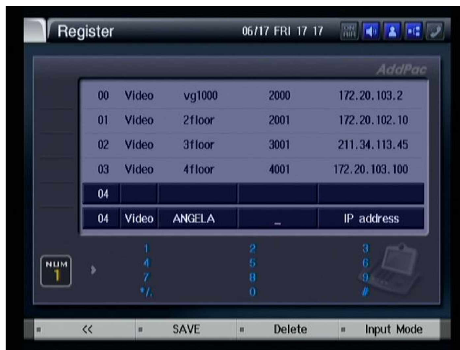
Рисунок 3-41 Удерживайте клавишу указанную на рисунке в течении 3 секунд для перемещения в секцию "Phone number"
