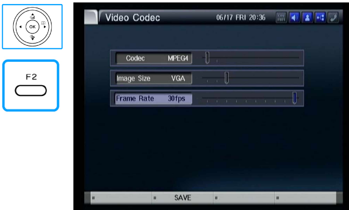
Рисунок 3-105 Выбор частоты передачи кадров (например: 30кадр/сек). Сохранение измененных параметров – клавиша F2.
