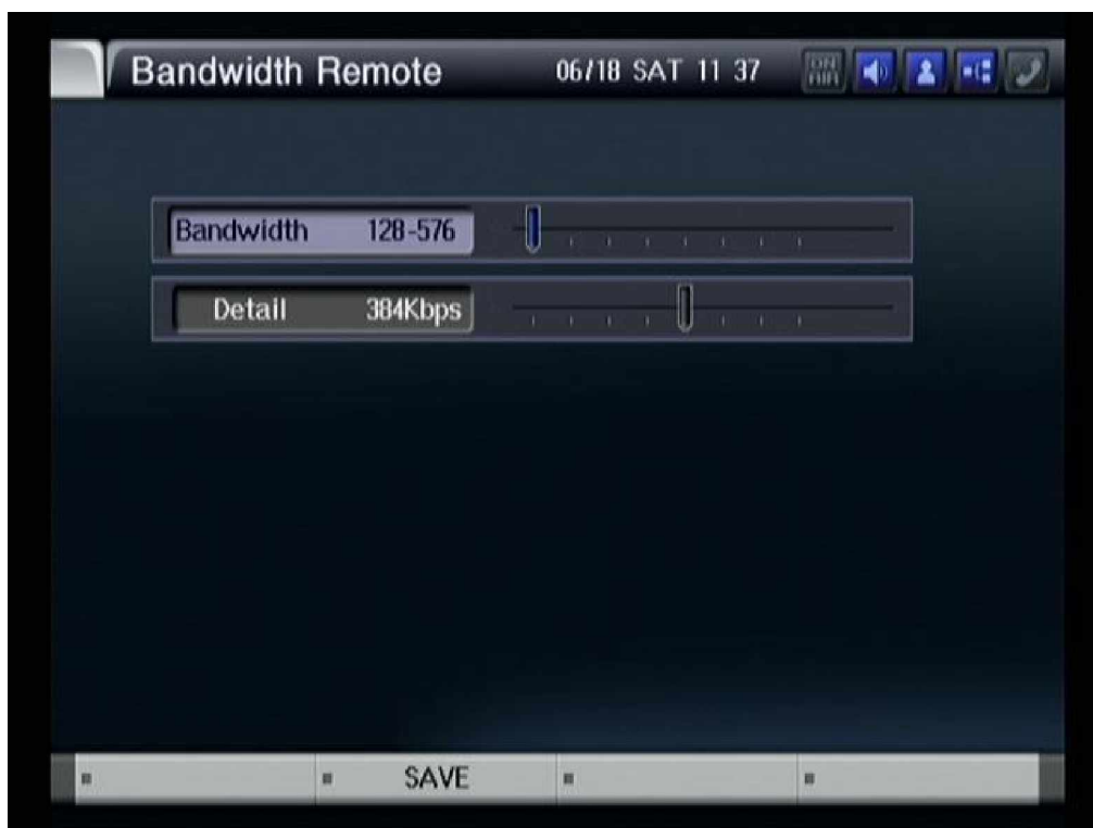
Рисунок 3-162 Меню "Bandwidth Remote" (пункт "Bandwidth" – грубая настройка полосы пропускания, пункт "Detail" – точная настройка полосы пропускания)
