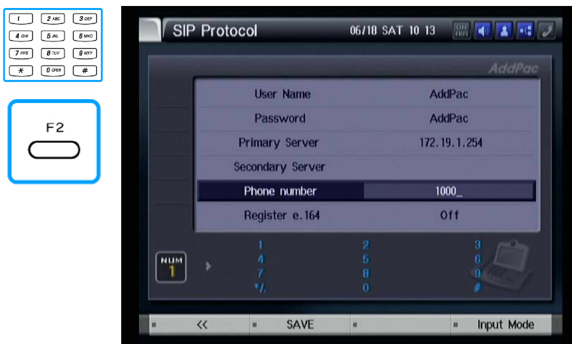
Рисунок 3-147 В поле "Phone number", введите номер телефона, закрепленный за AP-VP300. Сохраните изменения – клавиша 'F2'
