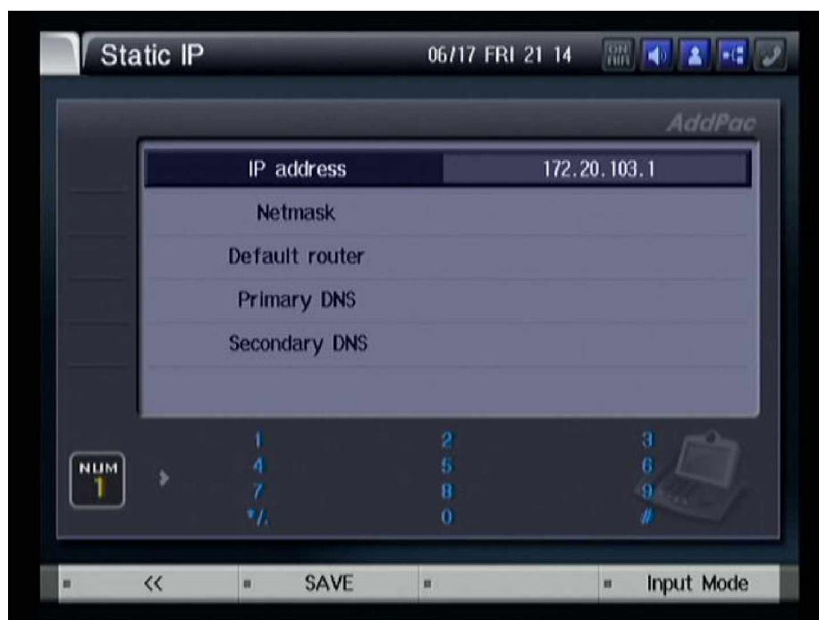
Рисунок 3-127 В меню "Static IP" в поле "IP address" введите IP адрес AP-VP300 (для примера: '172.20.103.1')
