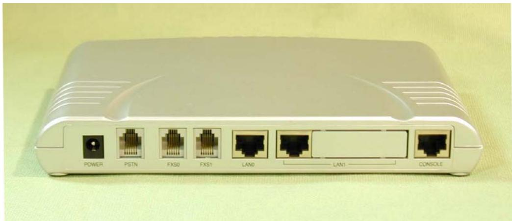
[Рис. 1-8 Фотография задней панели резидентного VoIP-шлюза VoiceFinder AP200 Model B]
