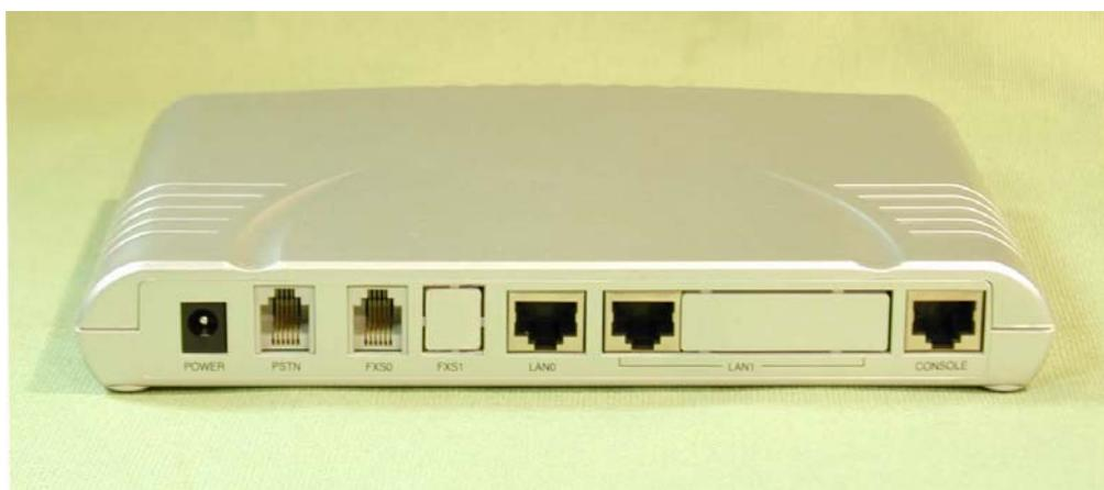
**[Рис. 1-10 Фотография задней панели резидентного VoIP-шлюза VoiceFinder AP200 Model C]**
