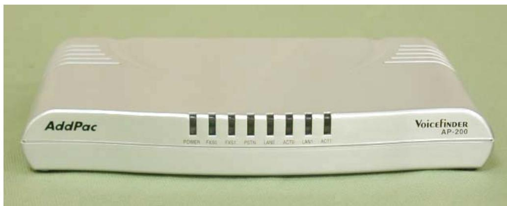
[Рис. 1-3 Фотография передней панели резидентного VoIP-шлюза VoiceFinder AP200]
