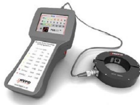
Приборы снабжены датчиками HFCT, TEV и акустическим для измерения акустического сигнала ЧР.
