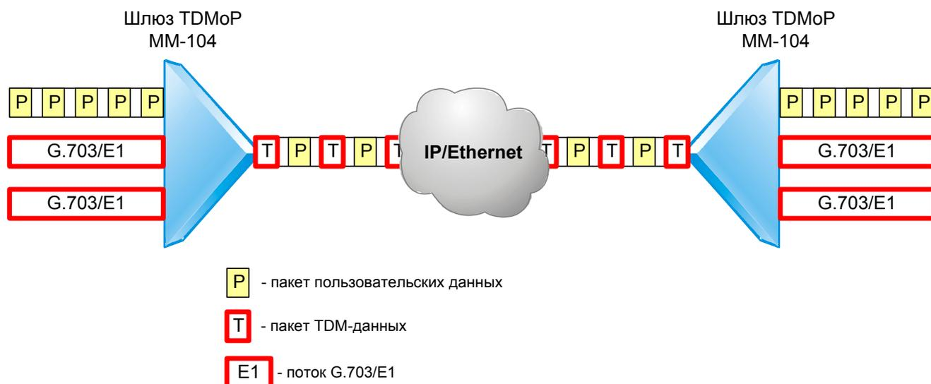
Рис. 1.1. Передача потоков E1 и пользовательских Ethernet-данных через сеть с коммутацией пакетов
