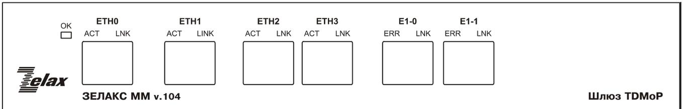
Рис. 3.2. Передняя панель шлюза в модификации с 2 портами E1.
