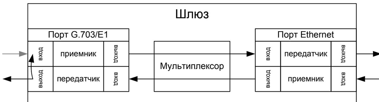
Рис. 6.4. Схема прохождения сигнала в режиме удаленного шлейфа.
