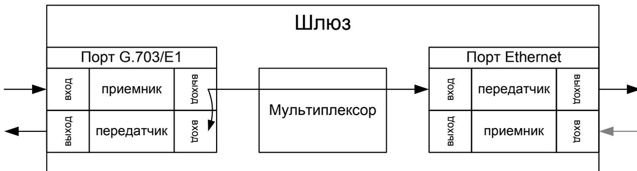
Рис. 6.3. Схема прохождения сигнала в режиме локального шлейфа
