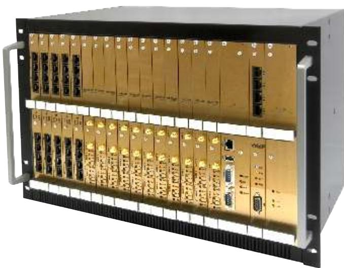
Topex multiAccess - член семейства Topex Media Gateways средней пропускной способности. Его основным функциональным назначением является соединение VoIP сетей с мобильными сетями.
