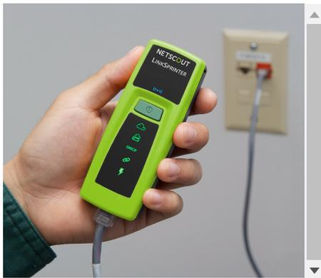
Карманный Ethernet-тестер LinkSprinter предоставляет полный спектр функций тестирования подключения к сети между двумя точками и автоматического создания отчетов в облаке нажатием всего одной кнопки. LinkSprinter используется службой поддержки ПК, передовыми специалистами, сетевыми инженерами и другими работниками для проверки подключения к сети, а также для проверки кабеля и правильности применения питания для устройств с поддержкой PoE.
