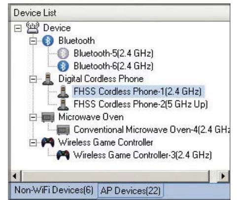
Рисунок 4: Обнаружение и классификация источников помех
