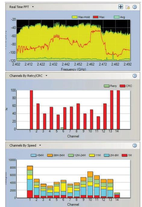
Рисунок 2: Анализ радиопомех и их воздействия на Wi-Fi
