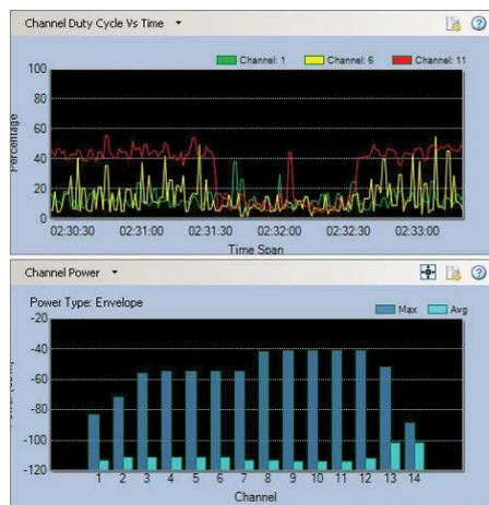
Рисунок 1-Б. Графики спектра РЧ
